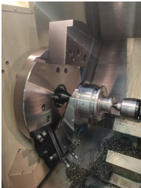
Рис. 1. Цапфа лапы бурового долота (диаметр 660,4 мм) в специальном приспособлении
