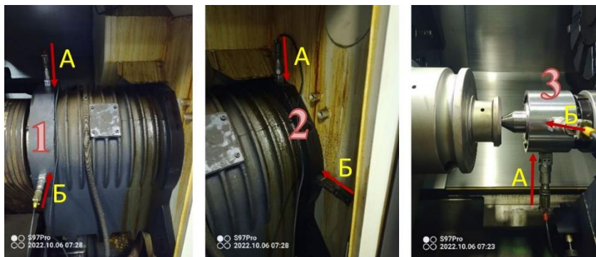
Рис. 2. Точки измерения вибрации. Вертикальная (точка А) / горизонтальная (точка В)
