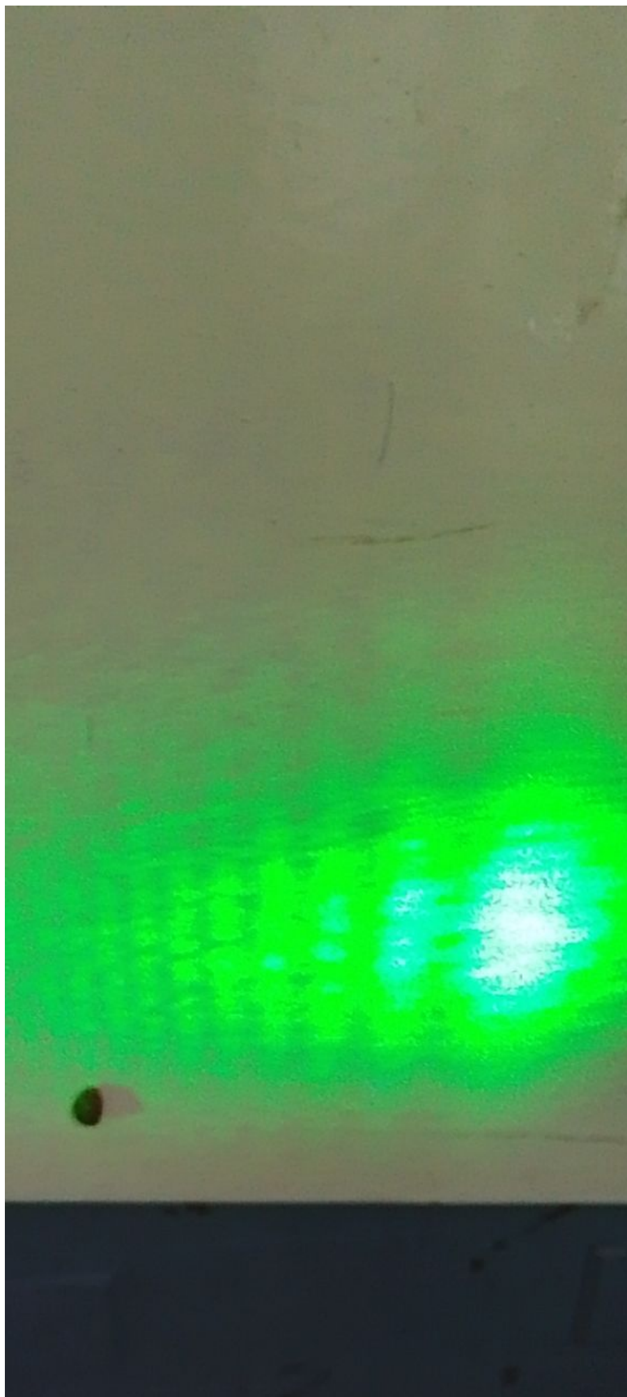
Рис. 5: Дифракционная картина при сечении потока, близком к появлению общей фоновой засветки. Положение максимума относительно метки остаётся неизменным
