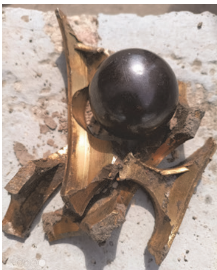
Рис. 6. Фотография фрагментов (сепаратор, шарик) разрушенного подшипника 32332 дымососа котла № 2
